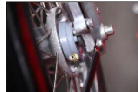
Insérer l'axe de la roue avant par le côté droit et tapoter légèrement pour le guider vers l'extérieur.
