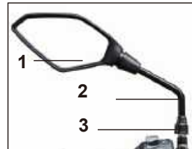
Couple de serrage de l'écrou: 3,4 Nm
