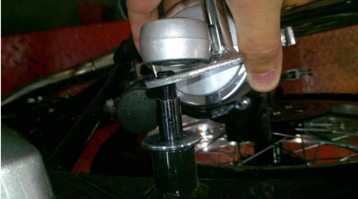
Remontage de l'amortisseur avec la rondelle originale, laissez la rondelle collée à l'amortisseur afin de glisser le porte paquet à l'intérieur (entre le cadre et la rondelle).
