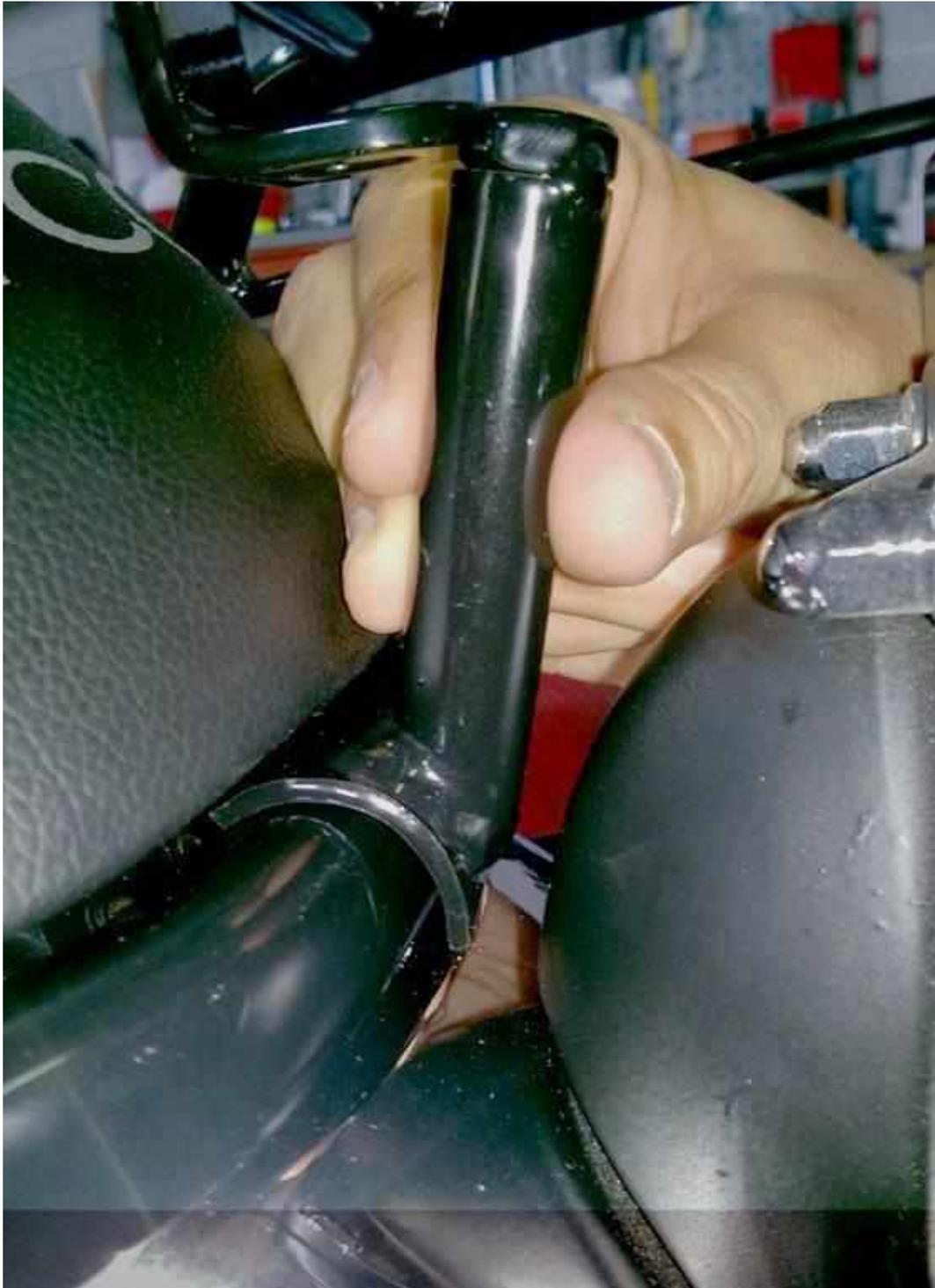
Montage du renfort arrière entre le support de plaque d'immatriculation et le garde boue arrière (vis 8x30 mm)
