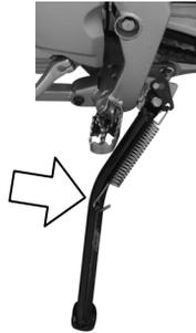
Pour positionner la béquille, appuyez avec votre pied sur son extrémité pour la rabaisser et en même temps, soulevez l'arrière de votre moto jusqu'à lever la roue arrière. Bloquez la béquille.
