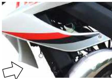
Le réservoir d'huile a une capacité de 1,04 litre et une réserve de 0,26 litres. Utilisez uniquement une huile 2T spécial graissage séparé.
