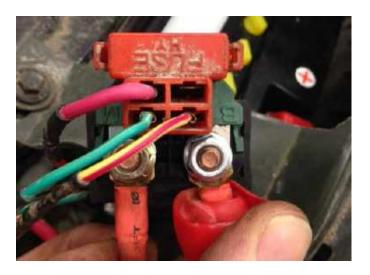
Si nécessaire, remplacer les cosses œillet diamètre 5 par des cosses de diamètre 6 sur les câbles de puissance.
