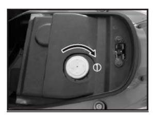
Soulever la selle pour permettre l'accès à la trappe à carburant, se référer page 12 de ce manuel, ouvrir le bouchon dans le sens inverse des aiguilles d'une montre et effectuer le plein du véhicule, la contenance du réservoir est de 6 litres, veillez à n'utiliser que du carburant sans plomb 95, pas d'utilisation de carburant E10. La fermeture du bouchon s'effectue dans le sens des aiguilles d'une montre comme représenté.
