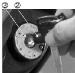
Pour déverrouiller le clapet de protection, engager le dos de la clé de contact comme représenté ci-contre et effectuer une rotation dans le sens horaire.
