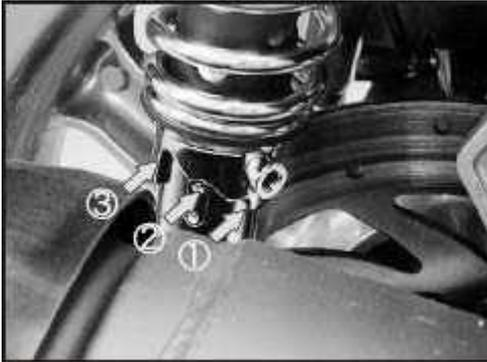
Les amortisseurs arrières de votre véhicule sont réglables en précontrainte, par rotation manuelle de la couronne suivant 5 positions : 1 étant la position la plus dure, 5 étant la position la plus souple (position N°4 et N°5 non représentées sur vue ci-dessus).
