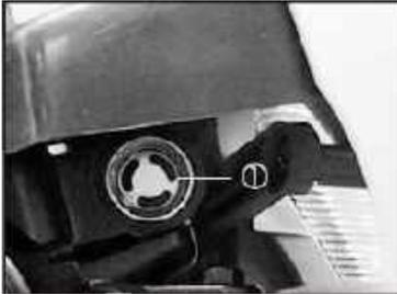
Le niveau de liquide de frein, ne doit pas descendre en dessous du repère « 1 », procéder de la même façon pour les deux leviers.
