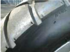
En aucun cas, la profondeur des sculptures ne doit laisser apparaître les témoins d'usure. Ceux ci se trouvent au centre de la bande de roulement et en face des repères « T.W.I » sur les flancs des pneumatiques (repère « A » sur photo).
