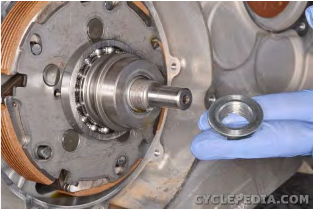
Remove the clutch nut.
