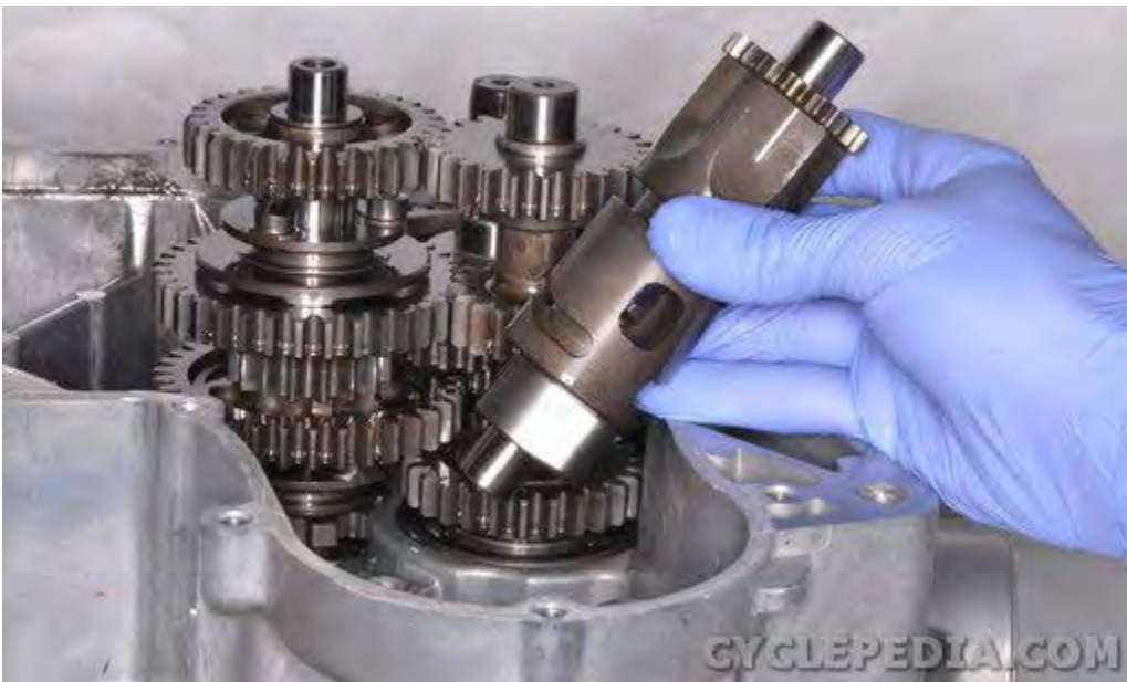
Remove the shift cam.
