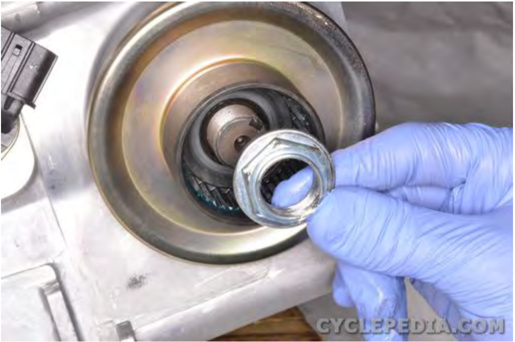
Remove output shaft nut.
