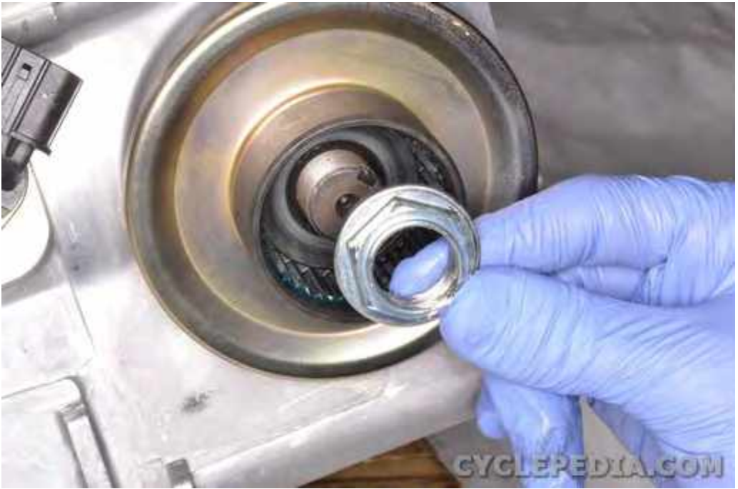
Remove output shaft nut.
