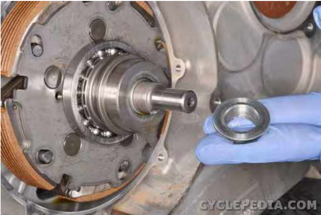
Remove the clutch nut.
