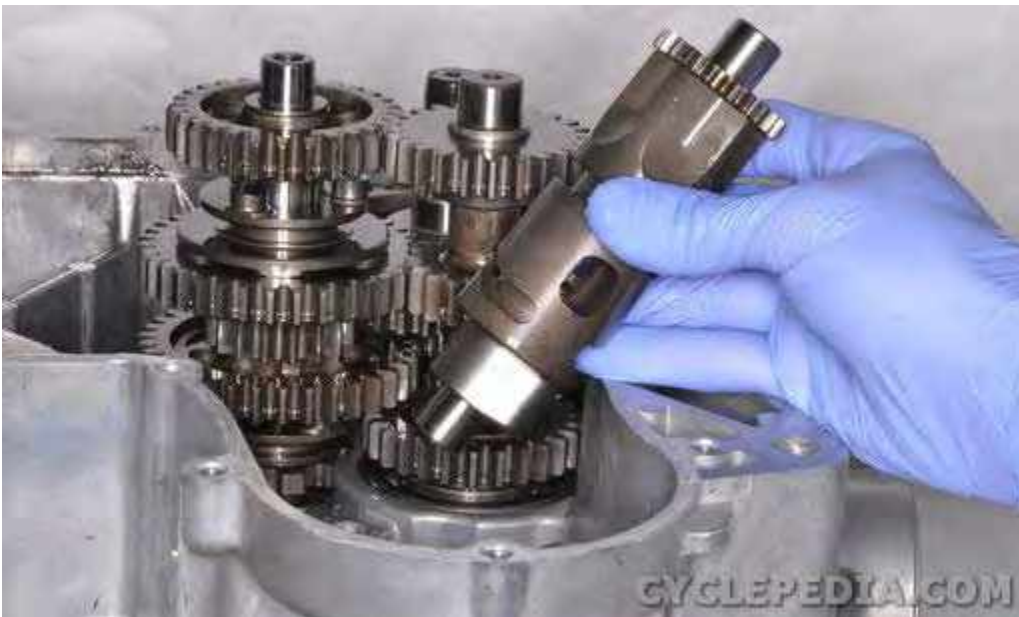
Remove the shift cam.
