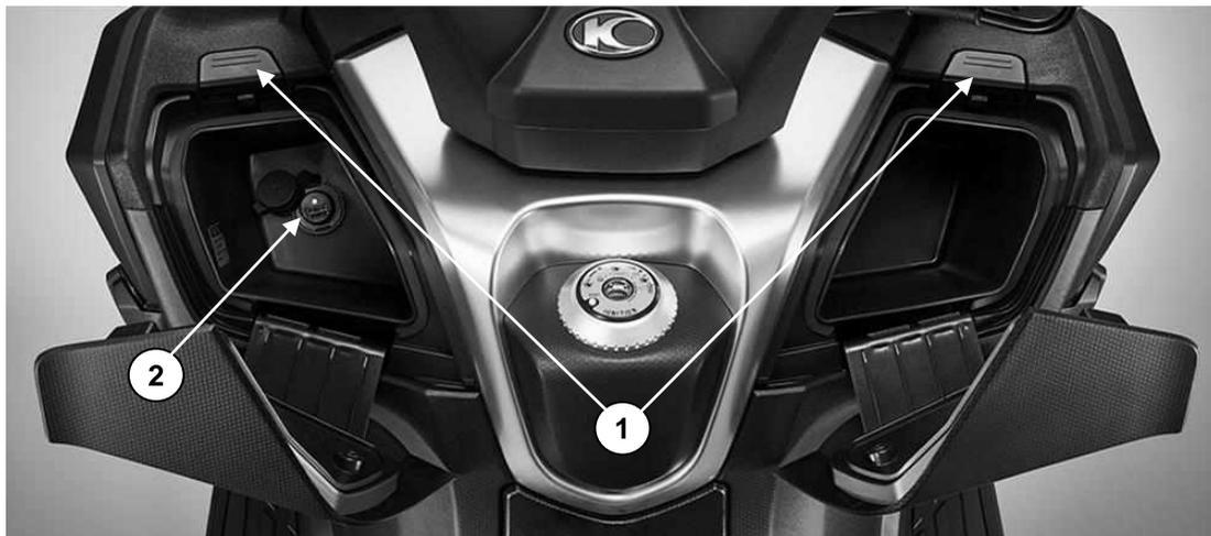
Le véhicule est équipé de 2 boîtes à gants
