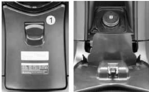
L'ouverture de la trappe d'accès au remplissage d'essence se fait par traction sur le loquet (1).
