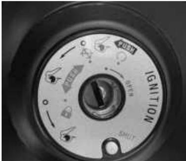
**AVERTISSEMENT** : Les scooters Euro 4 sont équipés de l'allumage automatique des phares (AHO). Les feux sont allumés en permanence dès la mise sous contact. Ne pas laisser le contact sur ON de manière prolongée. Risque de défaillance de la batterie.
