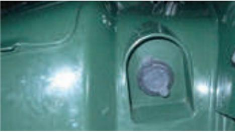
La prise Jack auxiliaire est située sur le côté gauche du véhicule. Elle peut être utilisée pour y brancher des éclairages auxiliaires, une radio.. Elle ne peut être utilisée que lorsque le moteur est en marche.
