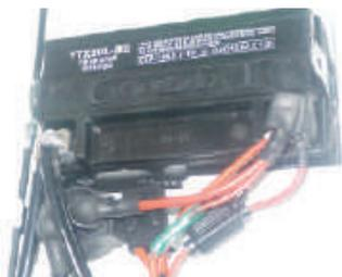
Ce modèle est équipé d'une batterie scellée (GTX20L-BS ou autres), qui ne requiert aucun entretien. Il n'est pas nécessaire de vérifier les électrolytes ou d'ajouter de l'eau distillée. Vérifier et si nécessaire, serrez les cosses de la batterie.
