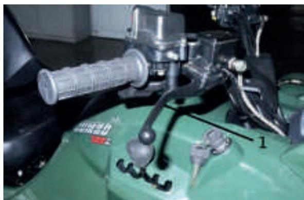
Le levier de frein avant est situé sur le côté droit du guidon. Serrez-le sur le guidon pour actionner le frein avant.
