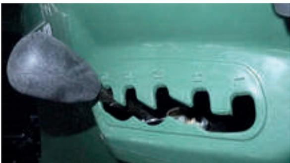
Le sélecteur de vitesse est utilisé pour faire passer les vitesses de vitesse courte / vitesse longue / point mort / marche arrière et position parking.
