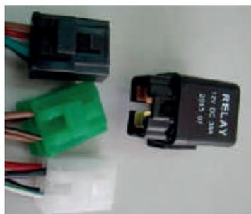
Pour le système EFI, le quad est équipé de trois relais additionnels pour la sécurité. Le noir pour le système EFI, le vert la pompe à carburant et le blanc pour le ventilateur.
