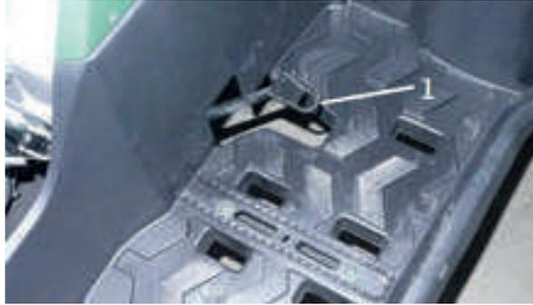
La pédale de frein est située sur le côté droit du véhicule et le levier de frein arrière est situé sur le guidon gauche. Appuyez sur la pédale de frein arrière pour actionner le freinage ou sur le levier de frein gauche.
