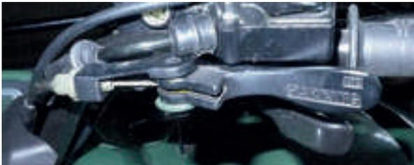
Utilisez le frein de parking quand vous devez démarrer le moteur ou garer le véhicule, spécialement dans une pente. Actionnez le frein de parking, déplacez le levier de frein de parking vers « ON ». Pour relâcher le frein de parking, redéplacez le levier vers la position « OFF ».
