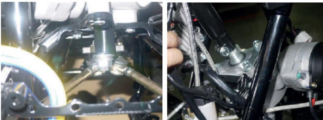
Utilisez un pistolet à graisse pour lubrifier les graisseurs de pivot.
