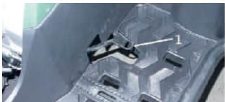
Le haut de la pédale doit être positionné à 58 mm du cale-pieds. Si la position de la pédale n'est pas bonne, faites le réviser par votre revendeur agréé.
