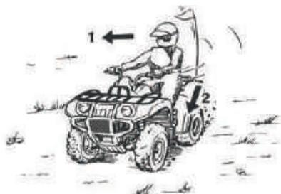
Afin d'obtenir plus de traction en roulant soit en 4x2 ou soit en 4x4, les roues arrières tournent ensemble sans la même direction. De plus, à moins que vous ne laissiez la roue intérieure au virage glisser ou dérapier, le véhicule tournera difficilement. Une technique spéciale doit être appliquée pour permettre au véhicule de tourner rapidement et facilement. Entraînez-vous à faible vitesse.
