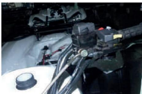
Le jeu de la manette de frein arrière doit être nulle car c'est un système hydraulique. Quand vous actionnez le levier de frein, la pression hydraulique presse l'étrier et le frein est actif immédiatement.
