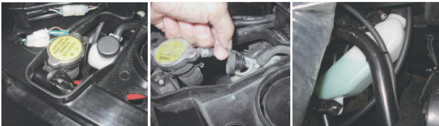
Une fois le moteur froid, placez le véhicule sur du plat. Ouvrez le cache avant sous le porte bagage et vérifiez que le niveau de liquide de refroidissement se situe entre les marques mini et maxi. Si le niveau est bas, ôtez le bouchon de réservoir. Rajoutez du liquide de refroidissement ou de l'eau distillée standard.
