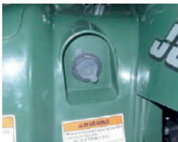
Ce quad est équipé d'une prise auxiliaire pour des équipements électriques de 12V. Le dispositif électrique total ne doit pas excéder 60W. Vérifier la tension et l'intensité des équipements avant de les brancher à la prise auxiliaire.
